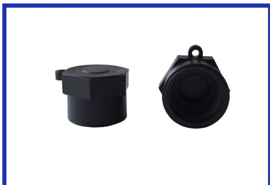
Tappo antipolvere DIN - UNI ISO 228 G 5/8x14
